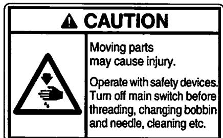
Les parties mobiles risquent de provoquer des blessures. Utiliser la machine équipée de ses dispositifs de sécurité. Mettre l'interrupteur principal sur la position d'arrêt avant d'entreprendre l'enfilage, le changement de la canette et de l'aiguille, le nettoyage, etc.
